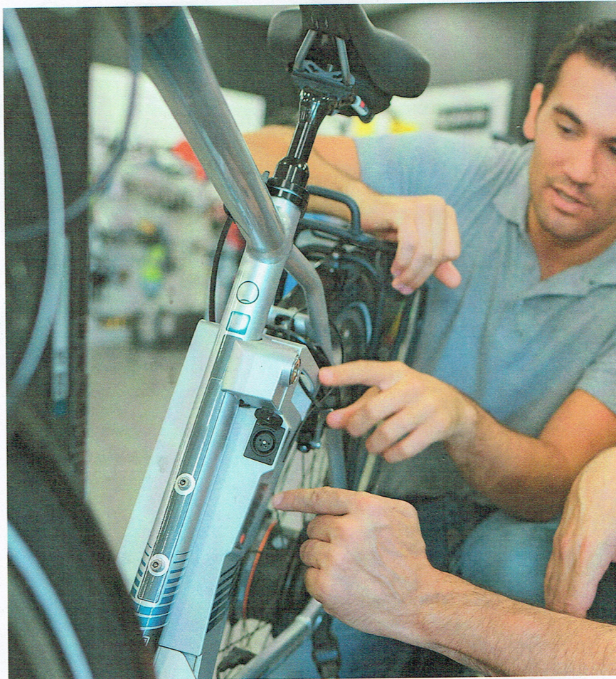
Velobatterie: Bei der Auffrischung werden die Batteriezellen im Innern ersetzt
